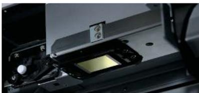
Il carico cartucce frontale facilita l'operatore nella sostituzione delle cartucce e riduce l'ingombro della macchina. È possibile regolare "on-the-fly" il registro tra stampa & taglio in fase di lavorazione, intervenendo su stampe complesse, dove il materiale è sottoposto a stress. Le evolute testite gold plated permettono di gestire la
